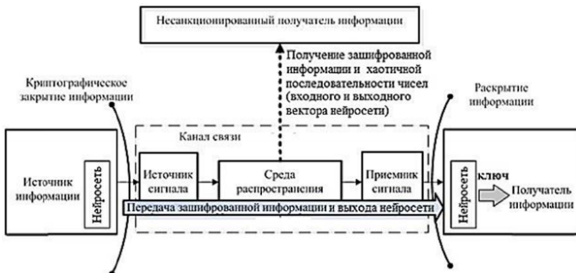
Рисунок 2.15 – Передача ключа с помощью нейронных сетей
